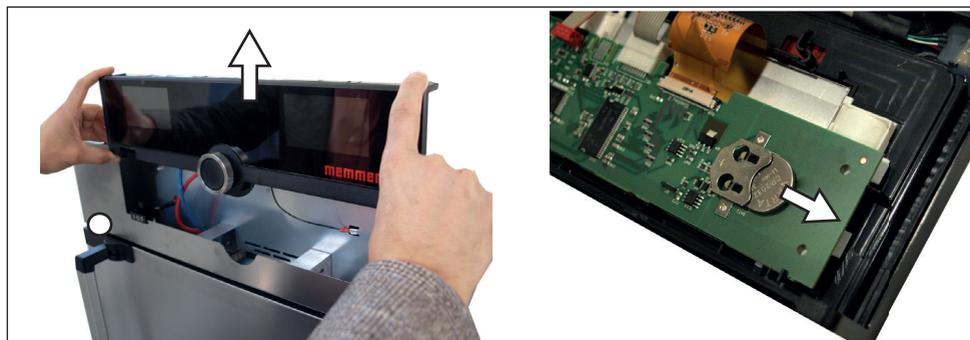
Abb. 34 Lithiumbatterie entfernen
