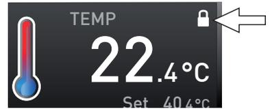
Abb. 31 Verstellen der Temperatur am Gerät gesperrt (Beispiel)
