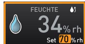
Hohe Luftfeuchtigkeit im Innenraum kann erst dann kondensationsfrei erreicht werden, wenn der Innenraum vollstandig durchgewarmt ist. Aus diesem Grund wird die Annaherungsgeschwindigkeit an den Feuchte-Sollwert dynamisch in Abhangigkeit von der Innenraumtemperatur geregelt.
