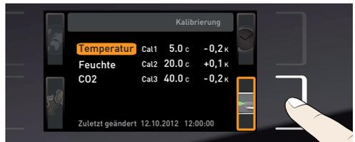
2. Drehknopf drehen, bis CO<sub>2</sub> markiert ist.
