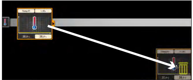
Fig. 5 Para eliminar un símbolo de parámetro de la línea de edición, empujar el símbolo hasta la papelera con el botón del ratón pulsado.
