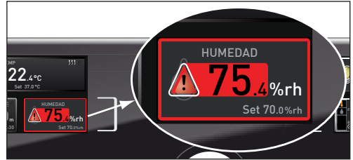
Fig. 22 El sistema de vigilancia de la humedad ha reaccionado.
