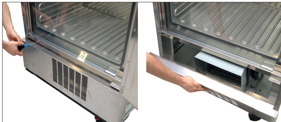
Ill. 32 Dévissage du panneau en façade
