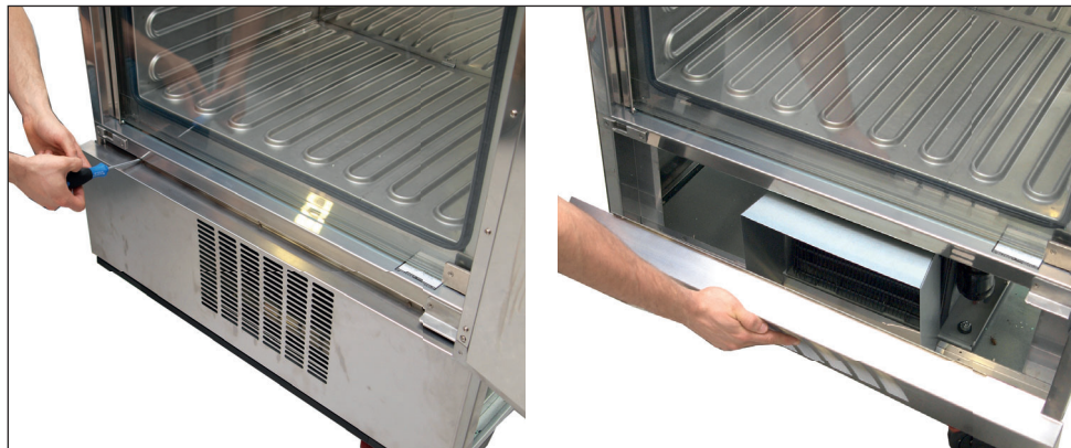
Рис. 32 Отвинтить переднюю панель
