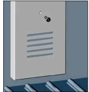
Abb. 36 Zum Abnehmen der Lüfterabdeckung zwei Schrauben entfernen
