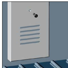
Ill. 36 Pour enlever le capot du dispositif de ventilation, dévisser les deux vis
