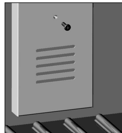
Fig. 36 Para retirar la cubierta del ventilador, extraer dos tornillos
