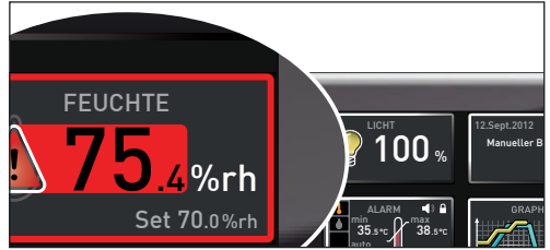
afb. 23 Vochtbewaking is aangesproken
