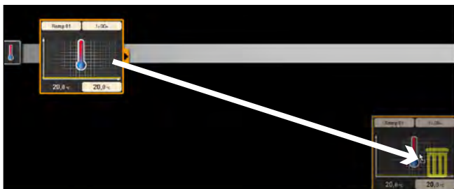
Ill. 5 Pour supprimer un symbole de paramètre dans un fil d'édition, sélectionnez le symbole en cliquant sur le bouton de la souris et faites glisser le symbole dans la corbeille prévue à cet effet en maintenant le bouton de la souris enfoncé.
