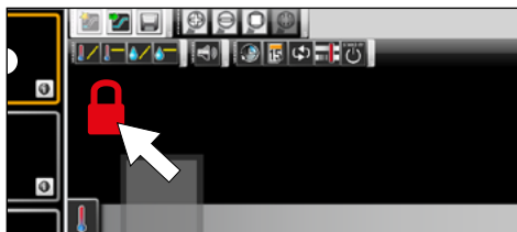
Ill. 12 Programme verrouillé pour éviter toute modification
