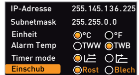
Abb. 23 Timer Mode: Timerlaufzeit beginnt erst, wenn ein Toleranzband von \pm 3 K um die Solltemperatur erreicht ist
