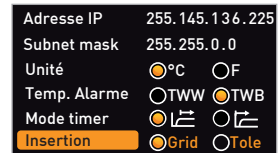
Ill. 23 Mode horloge : le cycle de programmation ne commence que lorsqu'une zone de tolérance de \pm 3\text{ K} par rapport à la température de consigne est atteinte.
