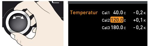
4. Einstellung durch Drücken der Bestätigungstaste speichern. Es wird automatisch der dazugehörige Abgleichkorrekturwert markiert.
