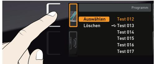
2. Funktion Auswählen durch Drücken der Bestätigungstaste aufrufen. Es werden alle verfügbaren Programme angezeigt, auch diejenigen, die sich auf dem USB-Datenträger befinden (erkennbar am USB-Symbol). Das derzeit zur Ausführung bereitstehende Programm ist orange hinterlegt.
