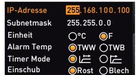
4. Auswahl mit der Bestätigungstaste bestätigen. Es wird automatisch der nächste Ziffernblock der IP-Adresse markiert. Auch dieser kann nun wie beschrieben eingestellt werden usw.
