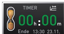
Zum Ausschalten des Timers die Timeranzeige durch Drücken der Aktivierungstaste erneut aufrufen, mit dem Drehknopf die Laufzeit so weit zurückdrehen, bis --:-- angezeigt wird, und mit der Bestätigungstaste übernehmen.
