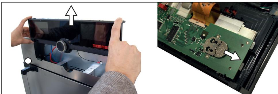
Abb. 30 Lithiumbatterie entfernen
