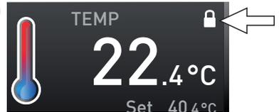
Abb. 29 Verstellen der Temperatur am Gerät gesperrt (Beispiel)
