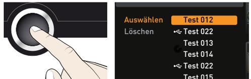
3. Mit dem Drehknopf das Programm auswählen, das zur Ausführung bereitgestellt werden soll.
