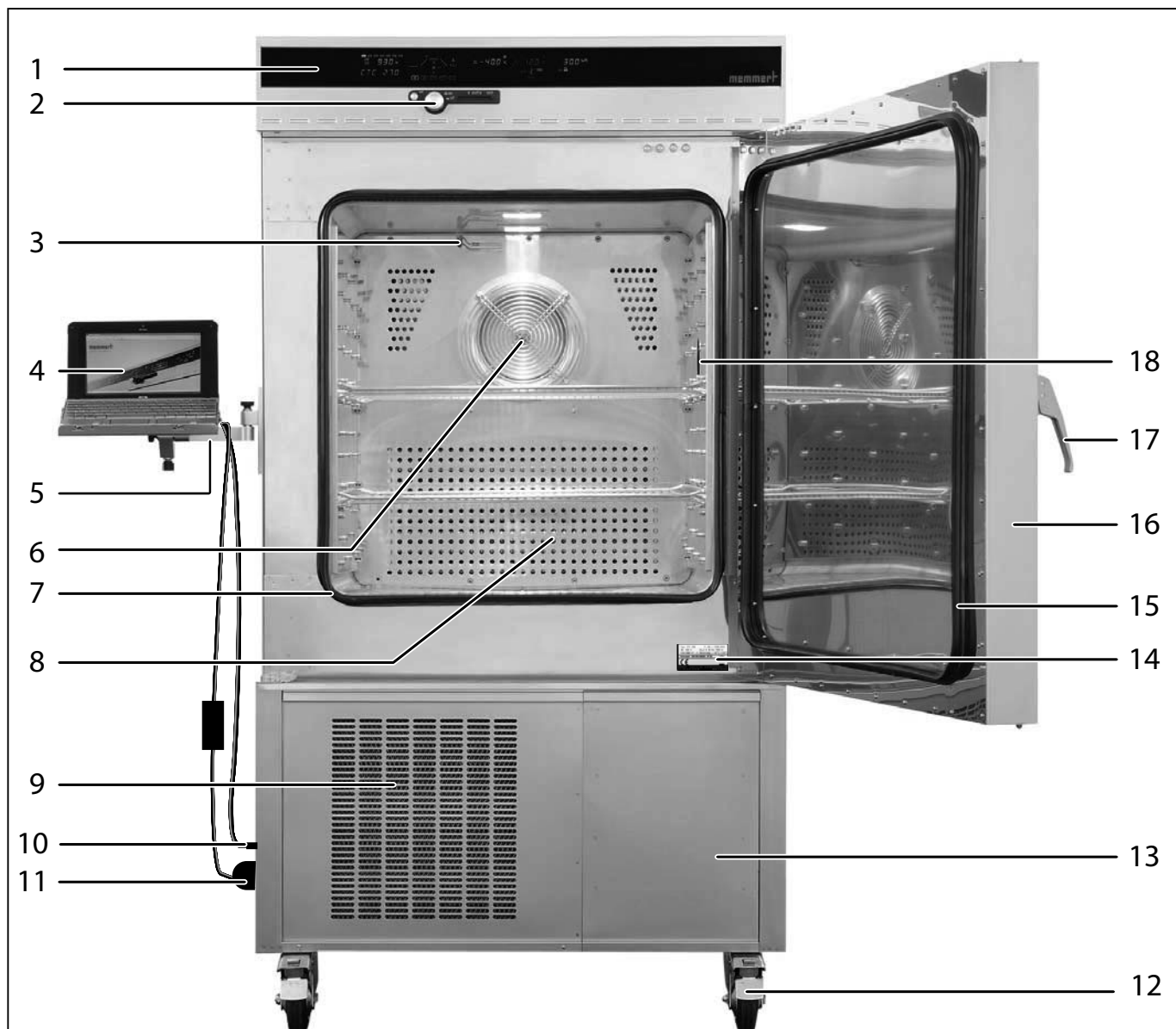
Fig. 3 Estructura de cámaras para pruebas térmicas frío/calor TTC y cámaras para pruebas climáticas frío/calor/humedad CTC
