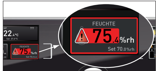
Abb. 22 Feuchteüberwachung hat angesprochen
