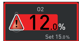
Fig. 25 El sistema de vigilancia de oxígeno ha reaccionado
