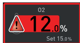
Fig. 24 El sistema de vigilancia de CO 2 ha reaccionado
