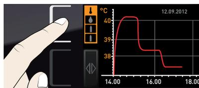
À l'aide du bouton rotateur, sélectionner le symbole de l'humidité ou l'un des symboles de la bouteille de gaz. Accepter la sélection avec la touche de validation.
