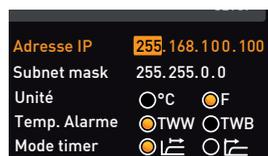
4. Accepter la sélection avec la touche de validation. Ceci sélectionne automatiquement le bloc de chiffres de l'adresse IP suivant. Régler également ce bloc comme indiqué ci-dessus, et ainsi de suite.
