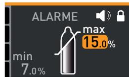
7. Pour confirmer, appuyer sur la touche de validation et pour quitter l'affichage ALARME, appuyer sur la touche d'activation sur le côté. Le dispositif de sécurité du CO<sub>2</sub> est maintenant activé.
