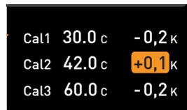
5. Régler le correctif sur 0,0 K et enregistrer ce réglage en appuyant sur la touche de validation.
