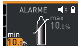
4. À l'aide du bouton rotateur, régler la valeur limite inférieure de l'alarme souhaitée, dans l'exemple à droite, 7 %.
