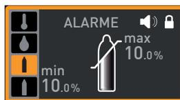
3. Accepter la sélection avec la touche de validation. La valeur limite inférieure de l'alarme est automatiquement indiquée.
