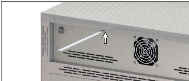
2. Plier le dispositif antibasculement vers le haut à la distance souhaitée pour former un angle à 90° avec le mur (veiller à laisser un écart minimal avec le mur, voir Ill. 8).
