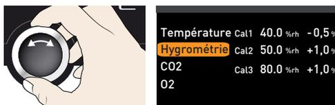
3. Appuyer sur la touche de validation jusqu'à ce que le point d'étalonnage CAL2 soit sélectionné.
