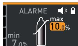
6. À l'aide du bouton rotateur, régler la valeur limite supérieure de l'alarme souhaitée, dans l'exemple à droite, 15 %.
