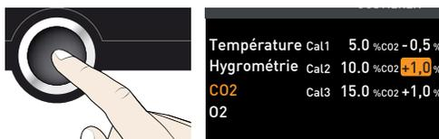
6. Régler le correctif d'étalonnage sur 0,0 % et enregistrer ce réglage en appuyant sur la touche de validation.
