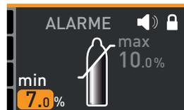
5. Accepter la sélection avec la touche de validation. La valeur limite supérieure de l'alarme est automatiquement indiquée.
