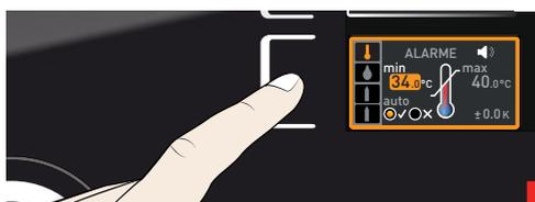
2. Accepter la sélection avec la touche de validation. Le réglage min. (protection en cas de sous-température) est automatiquement activé.
