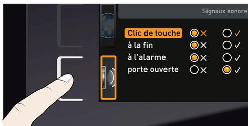
2. Si vous souhaitez modifier un autre élément de la liste : tourner le bouton rotateur jusqu'à ce que l'élément souhaité, par ex., porte ouverte (équipement spécifique), soit sélectionné en orange.
