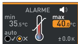
3. À l'aide du bouton rotateur, régler la valeur limite supérieure de l'alarme souhaitée, dans l'exemple à droite 38,5 °C.
