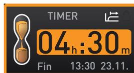
**1** L'heure est indiquée au format hh:mm (heures:minutes) jusqu'à 23 heures et 59 minutes ; au-delà de 24 heures, le format dd:hh (jours:heures) est adopté. La durée maximale d'un cycle est de 99 jours et 00 heure.
