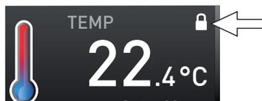
Ill. 33 Le changement de la température de l'appareil est verrouillé (exemple).
