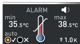
Dès que le dispositif de sécurité thermique est déclenché, cet événement est signalé dans l'affichage de la température par la température effective indiquée en rouge et par un symbole d'alarme ▲ (Ill. 18). Le dispositif de sécurité thermique responsable du déclenchement apparaît en dessous (dans cet exemple : TWW).
