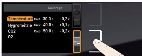
2. Appuyer sur la touche de validation jusqu'à ce que la température d'étalonnage Cal2 soit sélectionnée.
