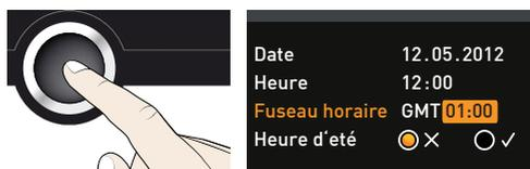
4. Avec le bouton rotateur, régler le fuseau horaire en fonction de la localisation de l'appareil, par ex., 00:00 pour le Royaume-Uni, 01:00 pour la France, l'Espagne ou l'Allemagne. Confirmer le réglage avec la touche de validation.
