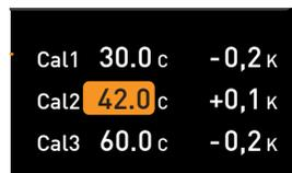
4. Appuyer sur la touche de validation pour enregistrer le réglage. La valeur corrective d'étalonnage correspondante est indiquée automatiquement.
