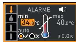
1. À l'aide du bouton rotateur, régler la valeur limite inférieure de l'alarme souhaitée, dans l'exemple à droite 35,5 °C.
