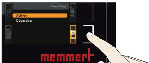
3. Appuyer sur la touche de validation pour confirmer l'activation. Les nouvelles données ID utilisateur sont transférées dans le support de données USB et sont activées. À la fin du processus d'activation, une coche apparaît devant la commande.
