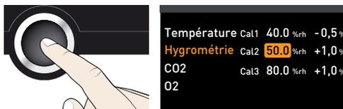
4. À l'aide du bouton rotateur, régler le point d'étalonnage Cal2 sur 60 % rh.
