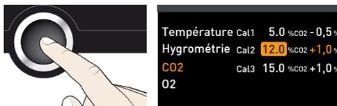
4. À l'aide du bouton rotateur, régler le point d'étalonnage CAL2 sur 10 %.
